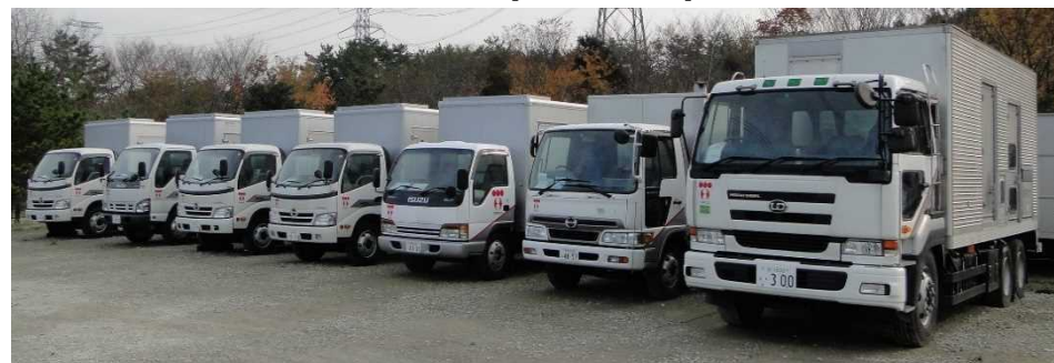
原子炉を冷やすためのポンプ等へ電気を供給する車両
