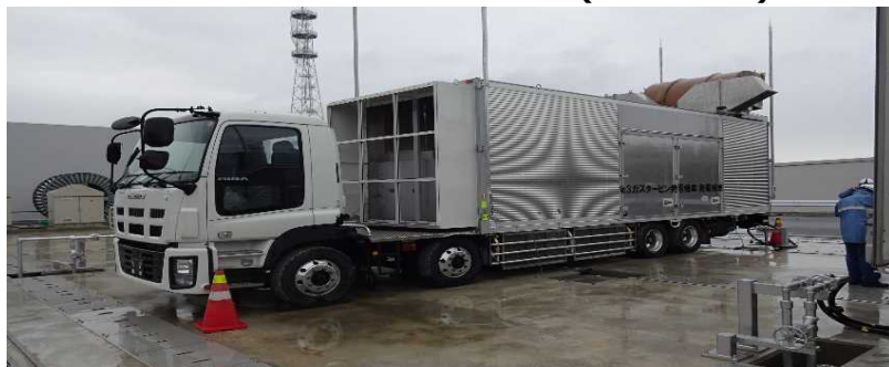
大容量の電気を供給する車両
