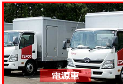
空冷式ガスタービン発電機車
