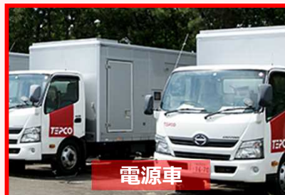
空冷式ガスタービン発電機車
