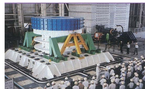
震動台による加震試験
