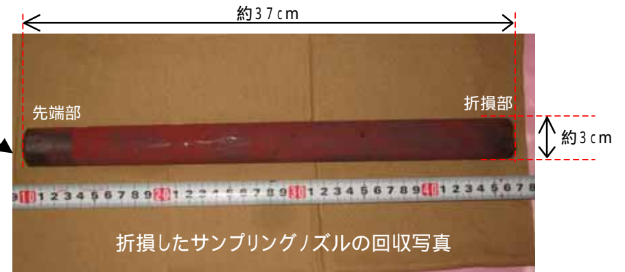
原子炉給復水系概略系統図及び折損したサンプリングノズルの回収写真
