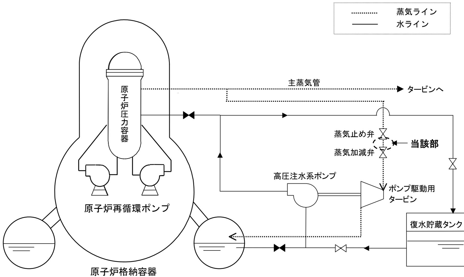
2号機高圧注水系蒸気漏えい概略図
