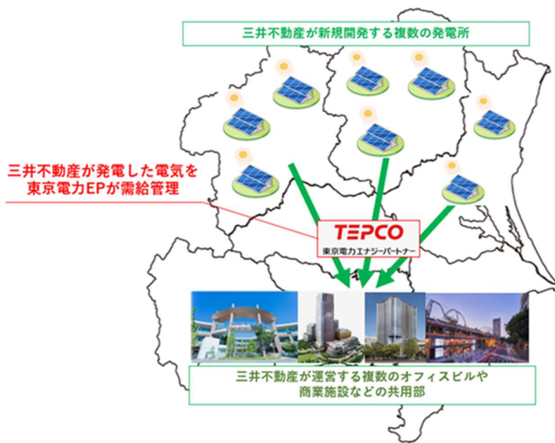
オフサイトフィジカルコーポレート PPA のスキームイメージ
