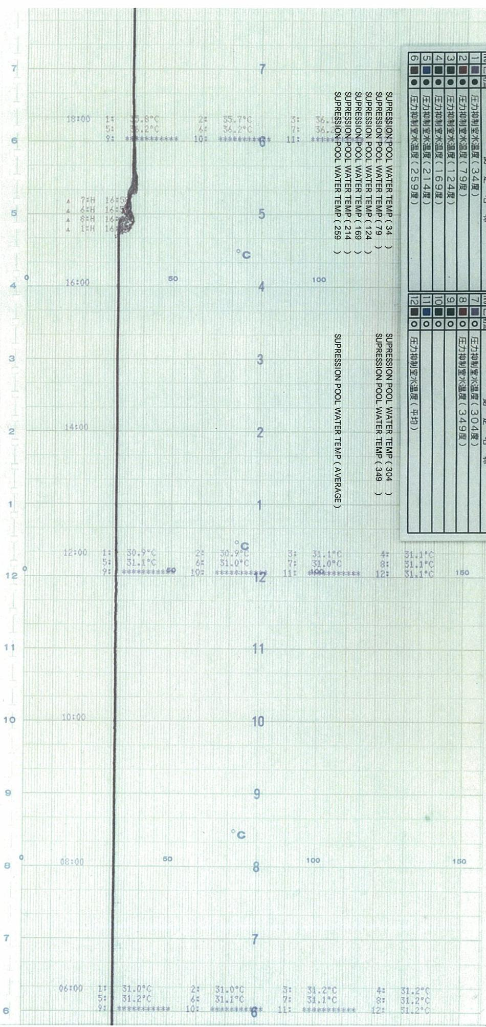
5号機 压力抑制室水温度(10 / 18)
