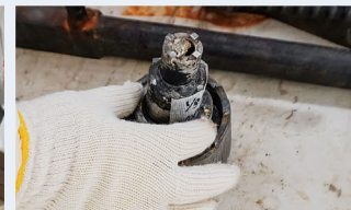
▲ 水を使わずに削孔するため、 先端部の消耗品は約1.6mの 掘削で1日1回取替 (汚染水を発生させない観点)
