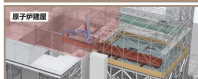
②輸送容器をクレーンで走行台車に積み前室から原子炉建屋へ移動
