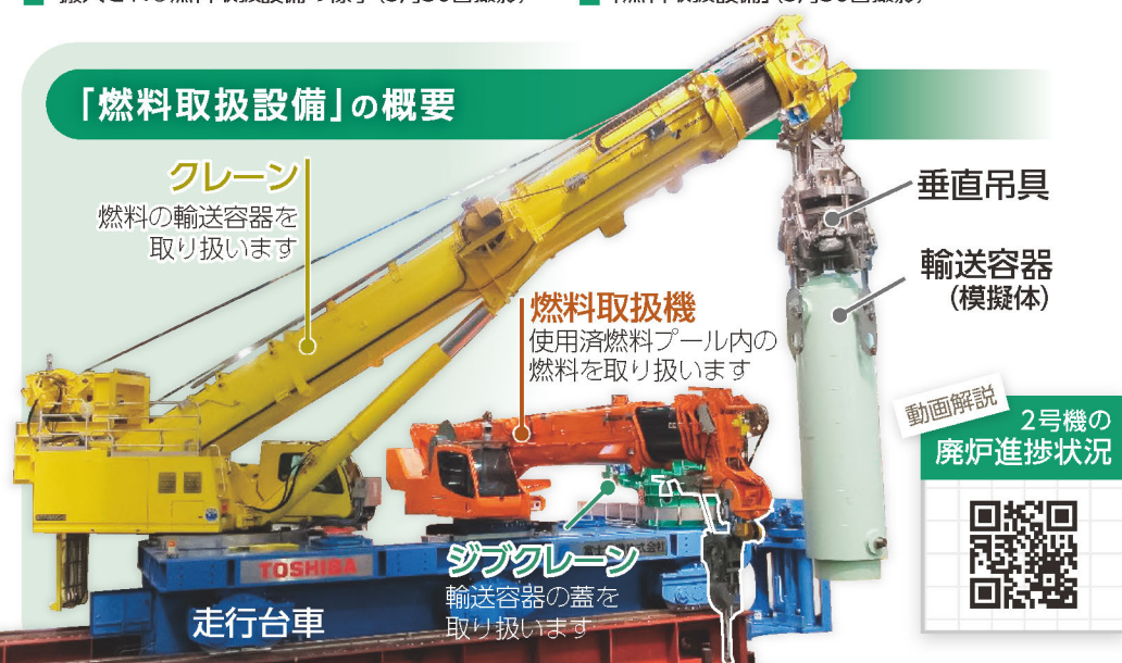
クレーンにより、2号機の燃料取り出し用構台へ搬入される燃料取扱設備の様子(5月30日撮影)
