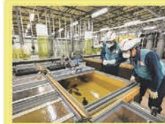
ALPS 処理水を加えた水槽 1,500ベクレル/リットル未満に調整
