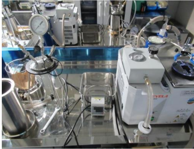
燃焼装置外観
