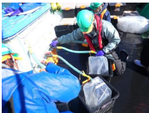
東京電力福島第一原子力発電所沖でH-3分析用の 表層海水試料を採取しているところ
