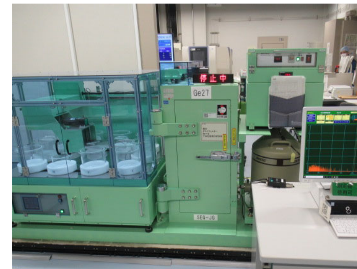
参考：既設ゲルマニウム半導体検出器 (写真は化学分析棟計測室内の装置)
