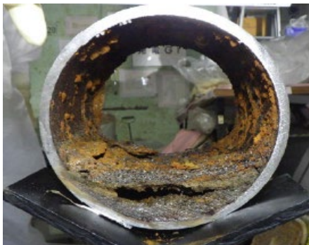
配管内の堆積物（サンプルB）
