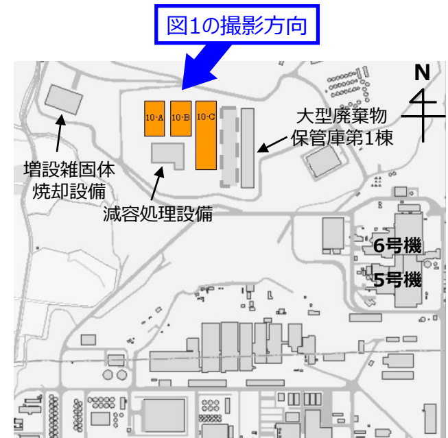
図2.固体廃棄物貯蔵庫第10棟の配置 (左からA・B・C)
