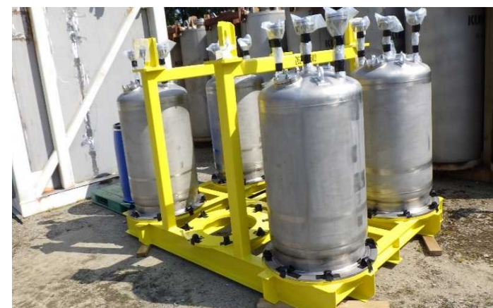
使用済吸着塔保管架台 (黄色いフレームを地元企業さまにて製造)
