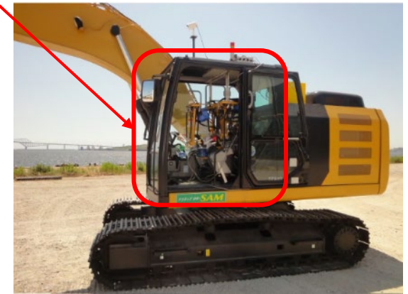
遠隔操作装置搭載重機
