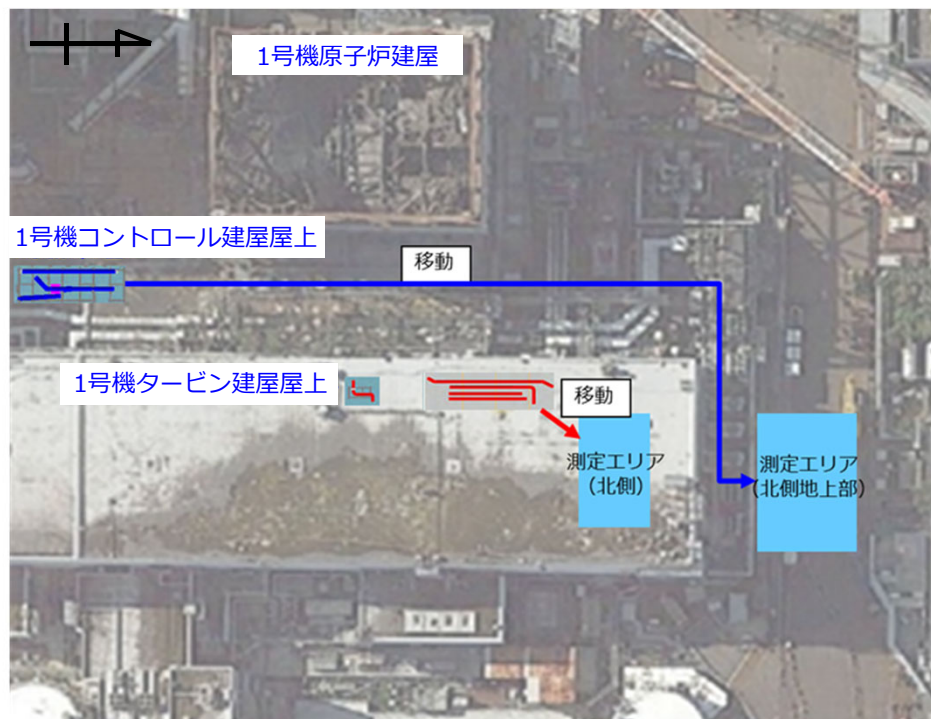
SGTS配管の仮置き状況および線量測定エリア
