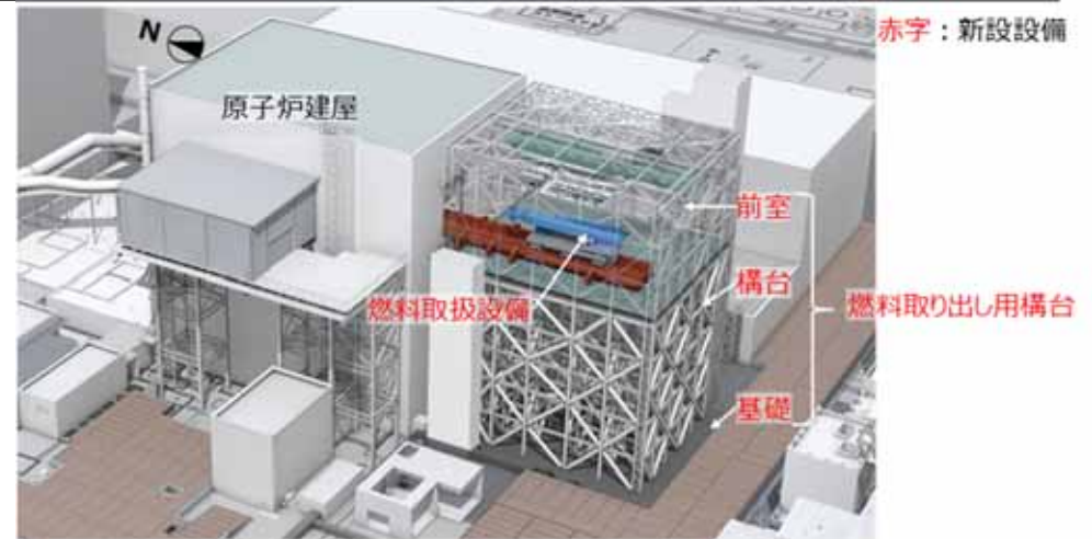
2号機燃料取り出し用構台 (イメージ)
