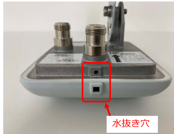
【写真：アンテナ水抜き穴】
