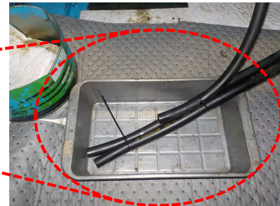
ブローバイガス排出ホース 吸着マット・オイルパン設 置状況（拡大）
