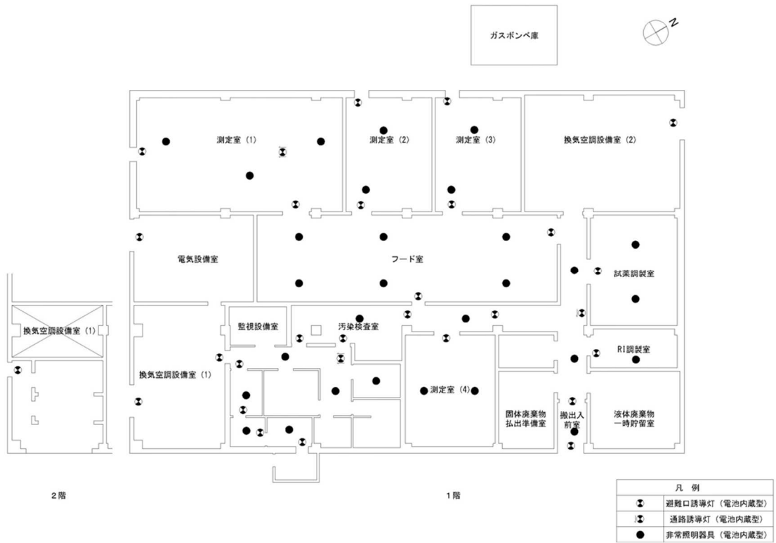
図－3 別棟の非常用照明配置図
