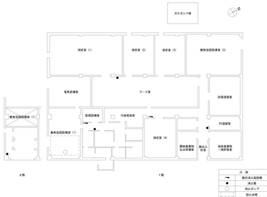
図－２ 別棟の消火設備配置図
