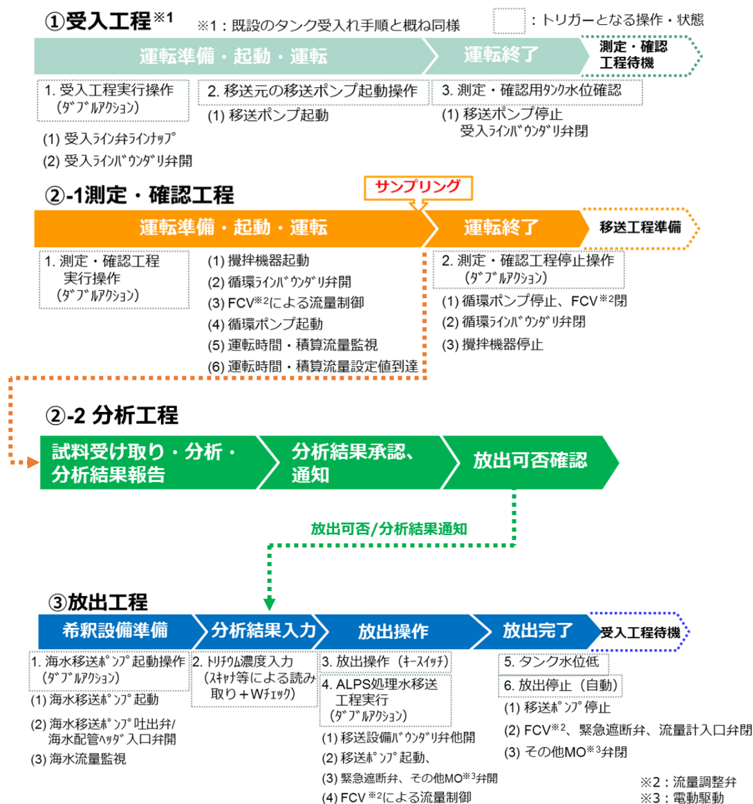
図－3 受入，測定・確認，放出工程の手順
