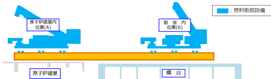
図 4.2.1-1 燃料取扱設備の位置
