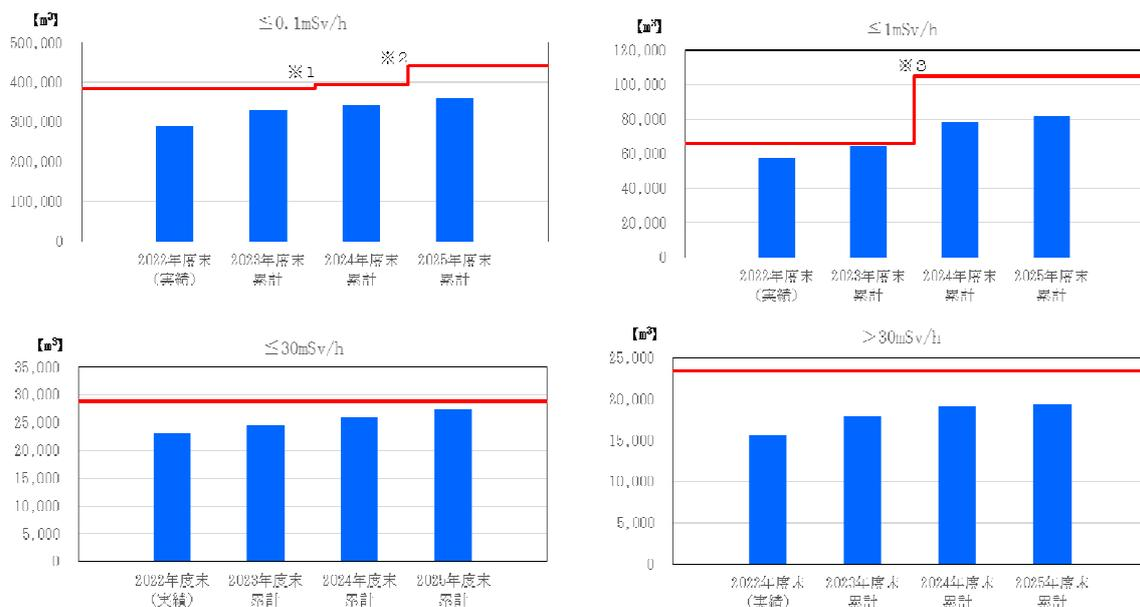
図2. 1. 1-2-2 瓦礫類の線量区分毎の想定保管量と保管容量の比較
