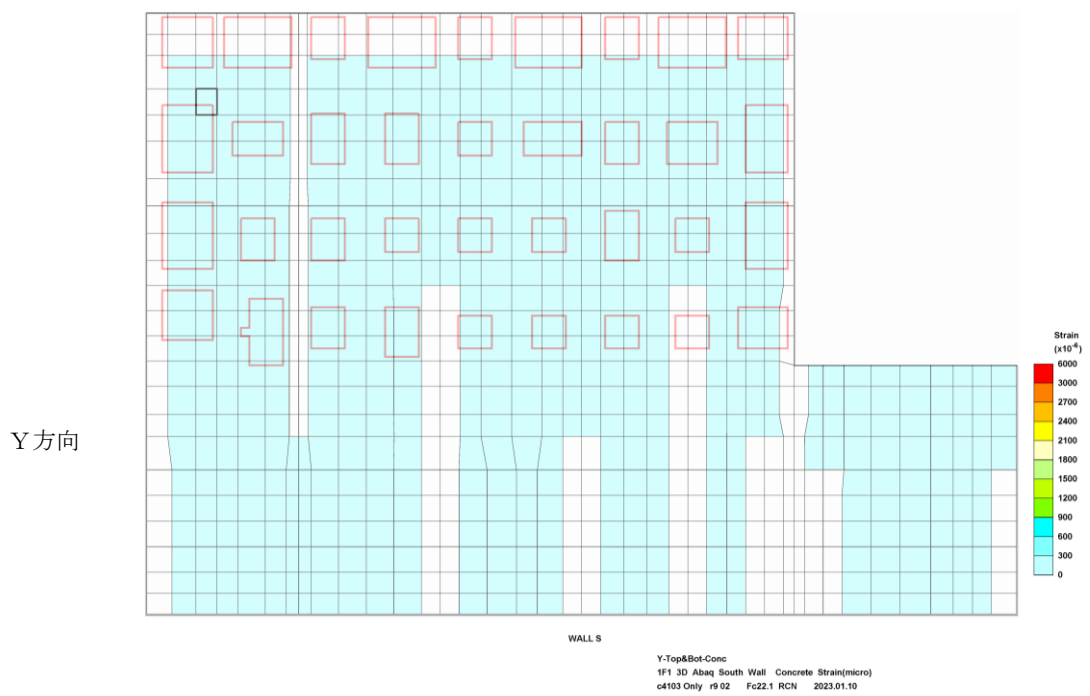
図-1.20 コンクリート圧縮ひずみの検定比 (建屋外壁南面)
