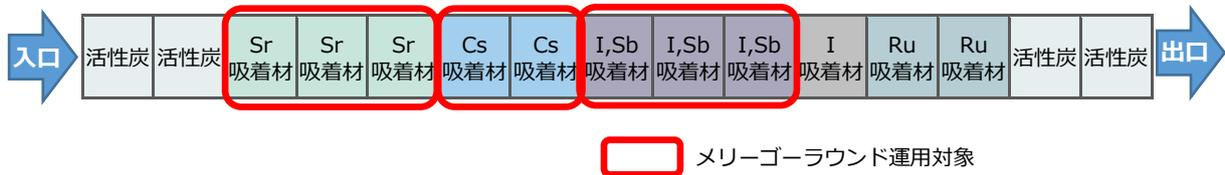
図 II-2 吸着塔構成の例（2018年9月時点での例）
