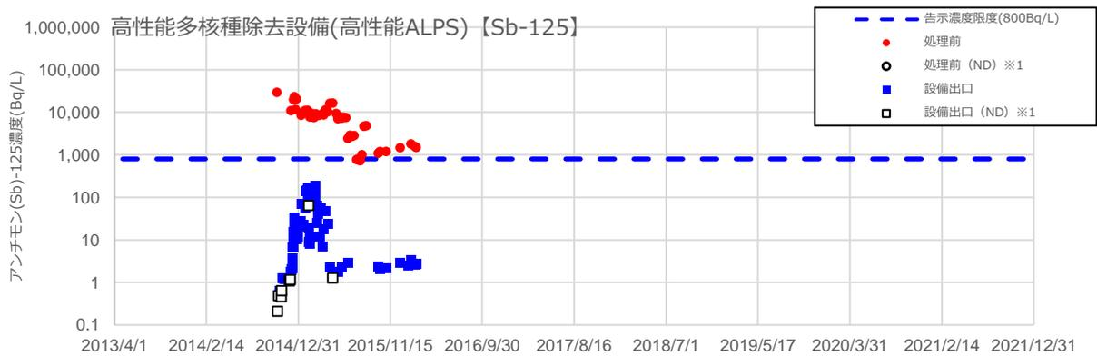
図 II-5-5 各多核種除去設備出入口における放射能濃度 (Sb-125)
