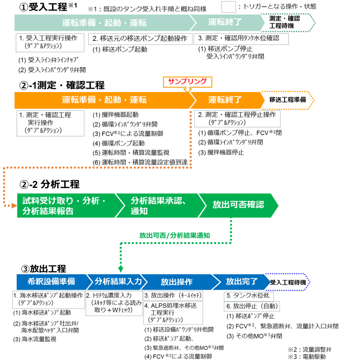
図-3 受入，測定・確認，放出工程の手順
