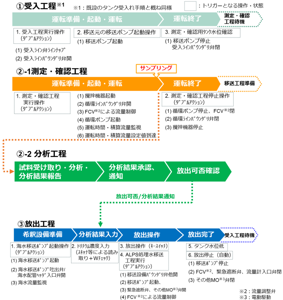
図-3 受入，測定・確認，放出工程の手順
