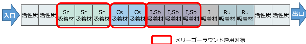
図 II-2 吸着塔構成の例（2018年9月時点での例）
