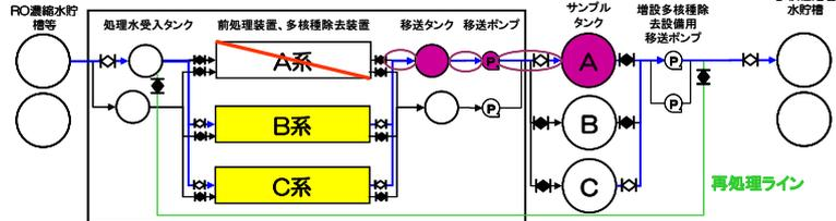
【STEP2：系統浄化確認後※にサンプルタンクA隔離&Bへ切替え】
