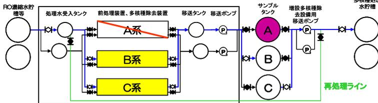
【STEP3：再処理ラインによるサンプルタンクの浄化（B/C系水源切替え：RO濃縮塩水→汚染したサンプルタンクA）】
