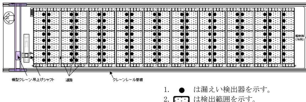
図 7 漏えい検出器設置図
