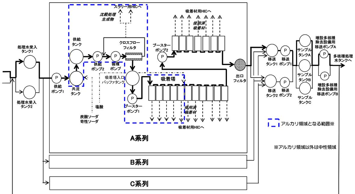
図1 増設多核種除去設備における液性
