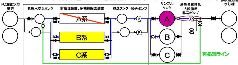
【STEP4：多核種処理水移送ポンプラインの浄化、サンプルタンクA除染】
