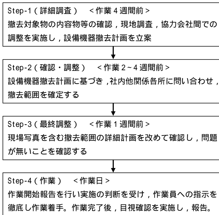
図2 設備機器撤去に伴う詳細調査・確認・調整業務フロー
