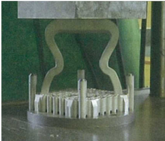
ハンドルを変形させる試験
