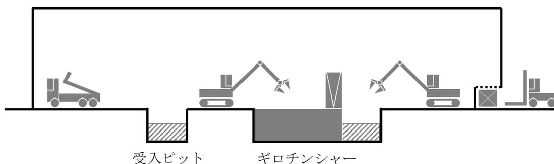
図-1 金属減容処理設備の処理フロー
