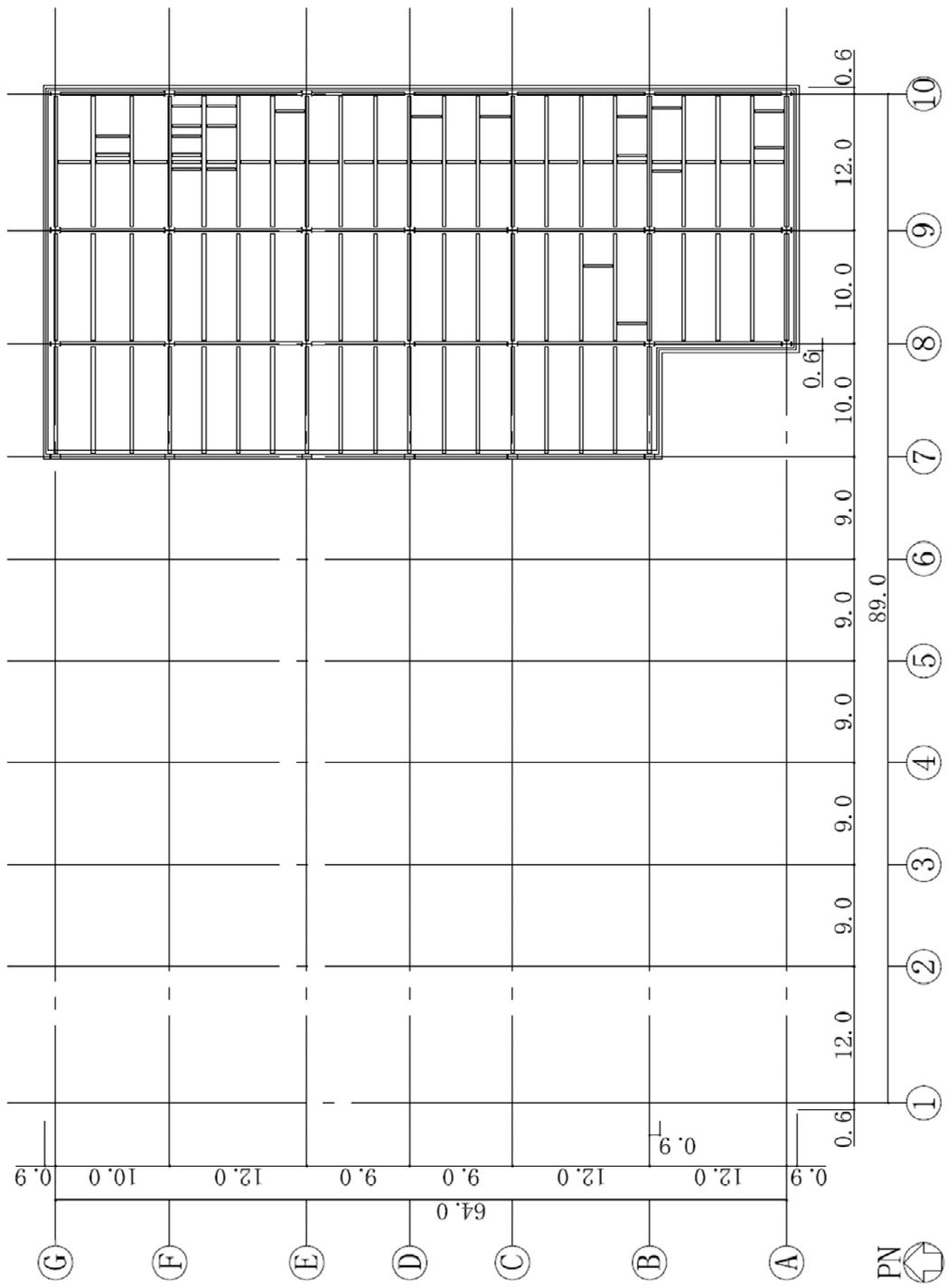
图-4 屋上階平面図 (G.L. +8.3) (单位 : m)
