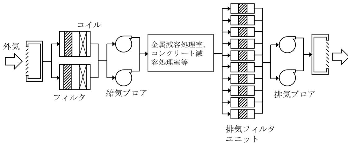
図-3 換気空調設備 系統概略図
