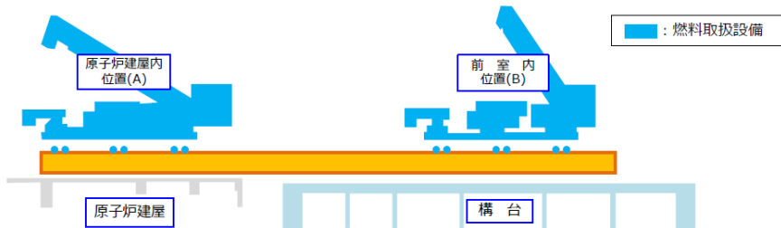
図 4.2.1-1 燃料取扱設備の位置
