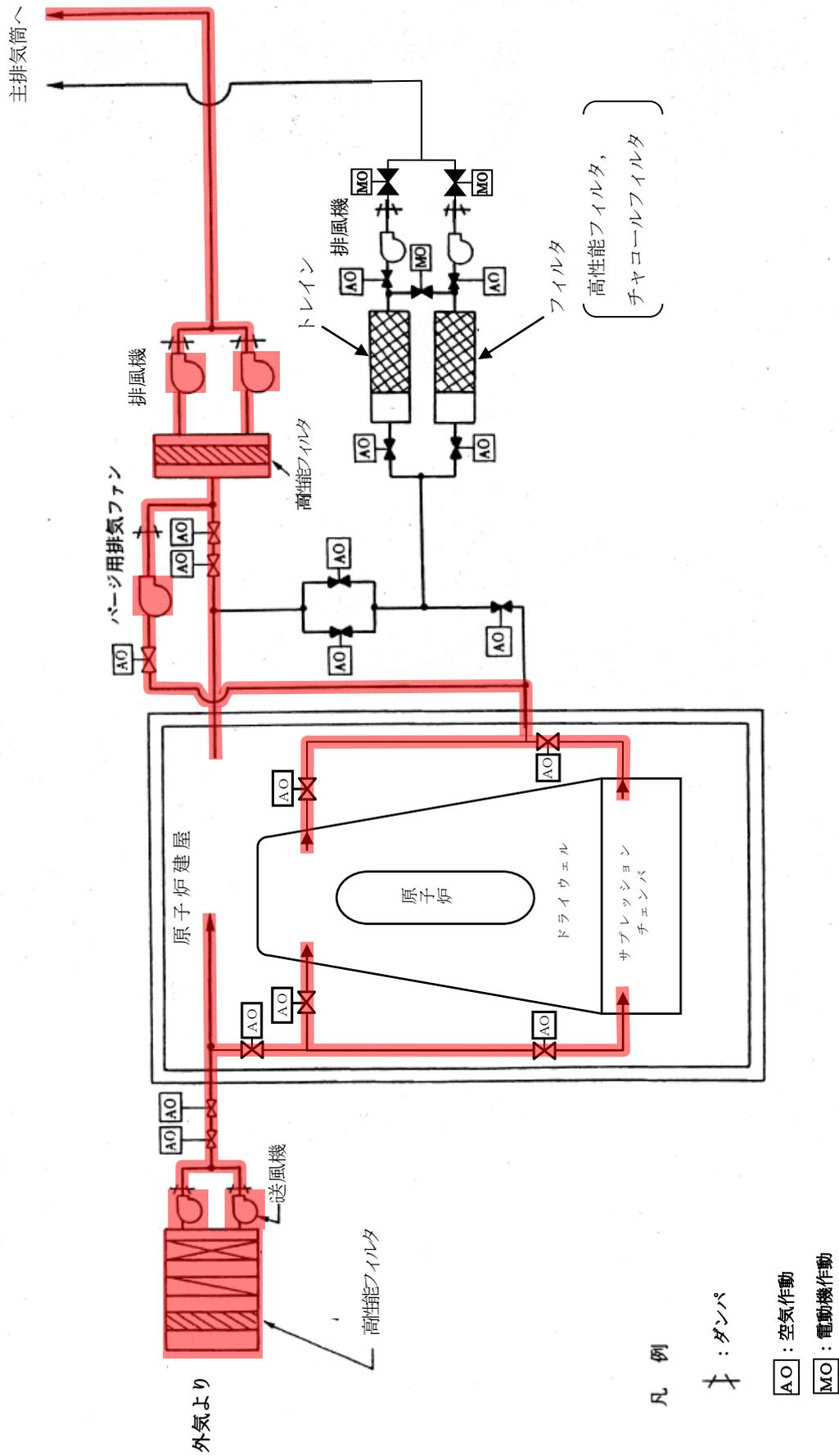
図-2 6号機 原子炉建屋常用換気系 系統概要図
