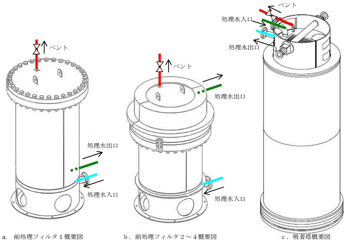
図2 前処理フィルター，吸着塔概要図
