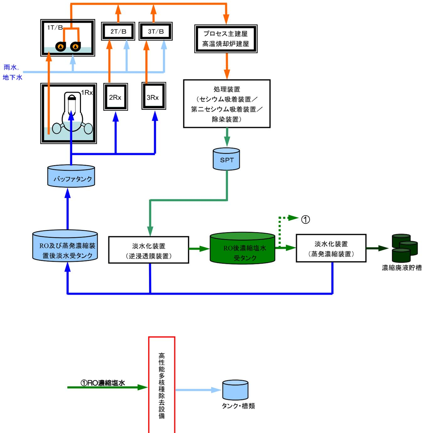
図-1 汚染水処理設備並びに高性能多核種除去設備等の全体概要図
