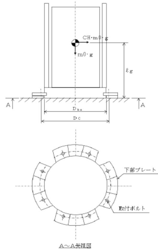
(9) 多核種吸着塔 1～20 (胴部材料：SUS316L)
