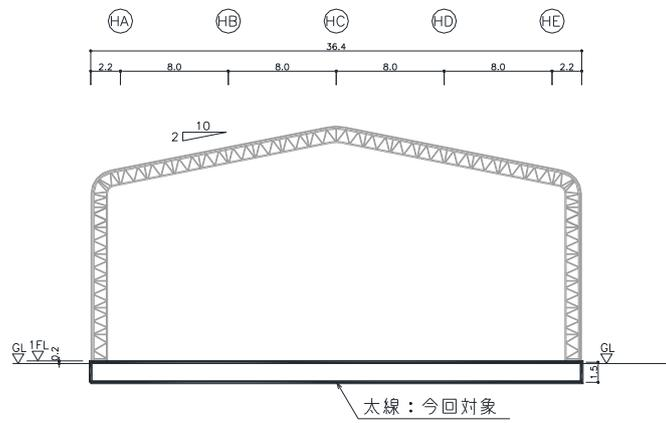
図-3 南北方向断面図 (単位：m)
