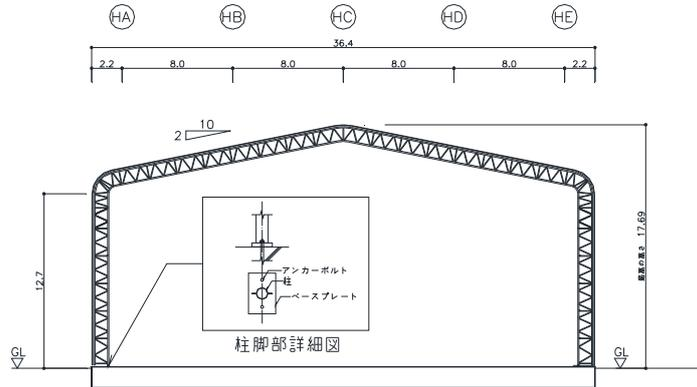
図-4 南北方向断面図 (単位 : m)
