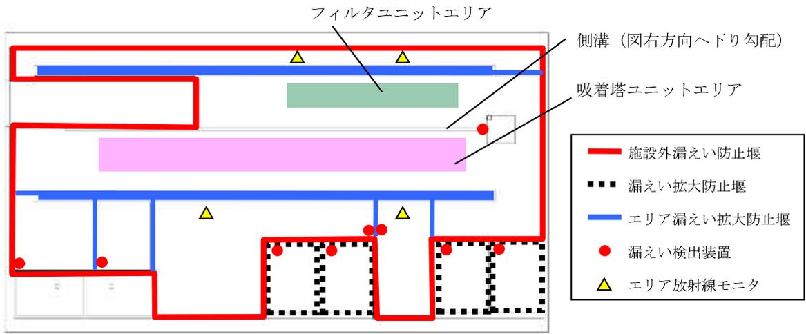
図1 堰及び漏えい検出装置等の配置概要（上から見た図）
