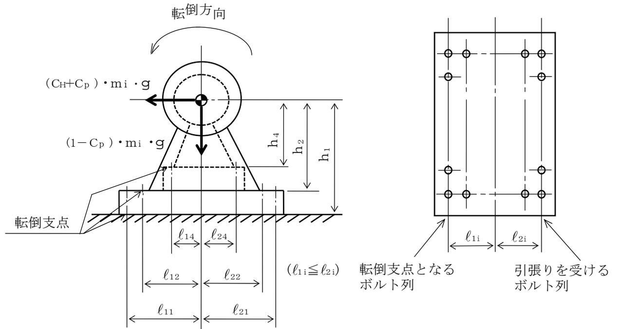
図 2-1 計算モデル (軸直角方向転倒)
