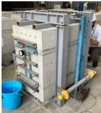
写真1 加圧試験状況
