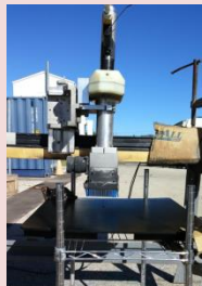
塗装剥離試験の様子
