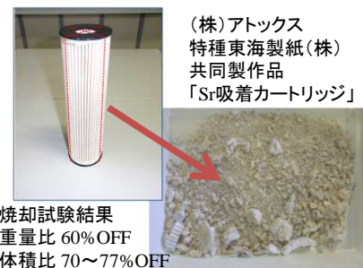
Fig.6 吸着カートリッジと焼却結果
