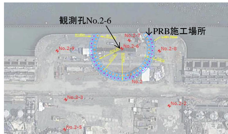
図4 福島第一原子力発電所への適用例 (2,3号機取水口付近)
