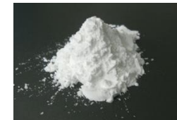
図2 捕集材の例(ゼオライトA)
