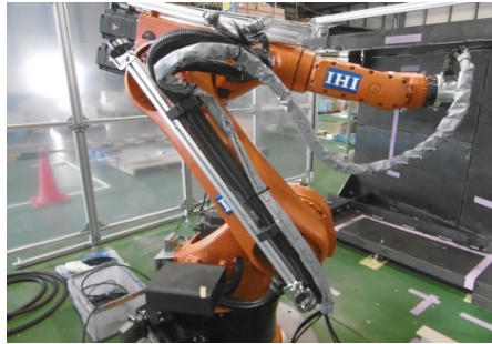
先端ツール動作確認試験の様子
