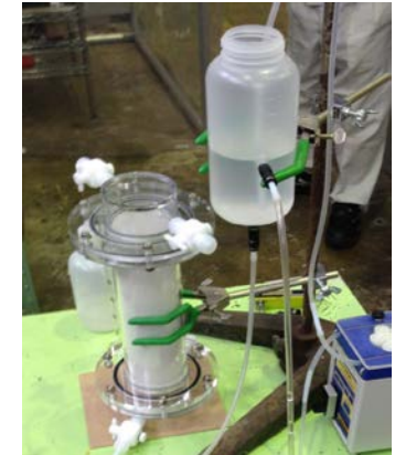
吸着繊維の透水性確認試験装置
