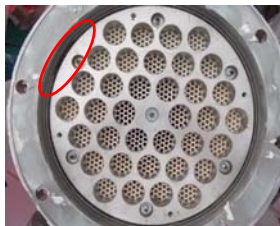
CFF3Bプレートガスケット欠損箇所：幅約6cm、深さ約3mm
