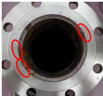
①吸着塔2C点検口フランジ部の腐食の様子
