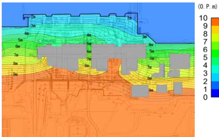
現況の地下水位（建屋周辺のサブドレン停止中）
