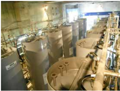
吸着塔（ベッセル）の現場写真
