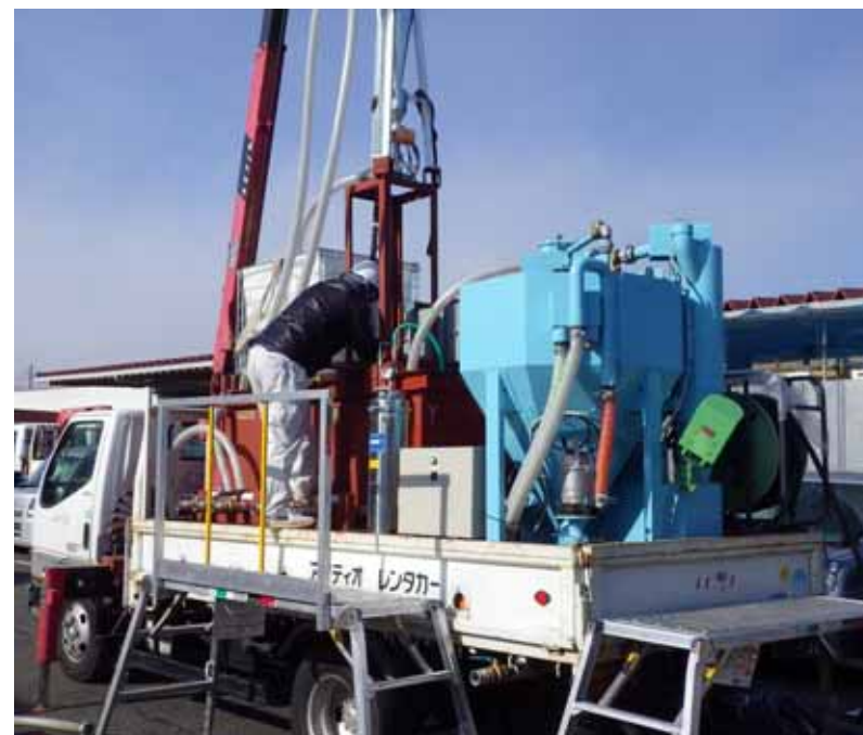
構外における浮遊物質除去プラントの組立状況
