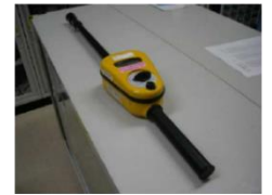
線量計(テレケタ) 型式: 6112D/H メーカー: オートメス 測定レンジ: 0.01mSv/h-9999mSv/h
