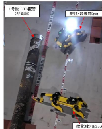
Spotによる配管線量測定イメージ
