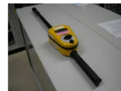
線量計(テレケタ) 型式: 6112D/H メーカー: オートメス 測定レンジ: 0.01mSv/h-9999mSv/h
