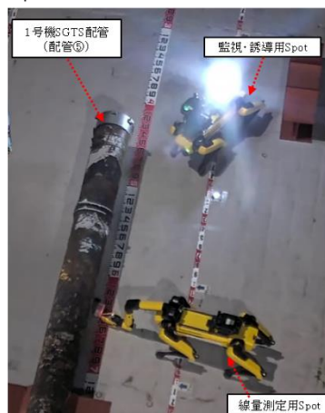
Spotによる配管線量測定イメージ
