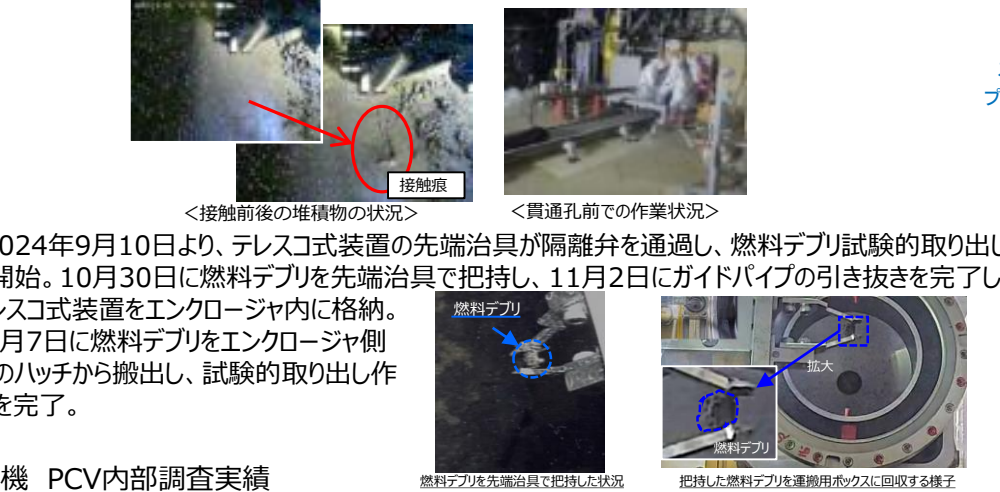
2号機 PCV内部調査実績
