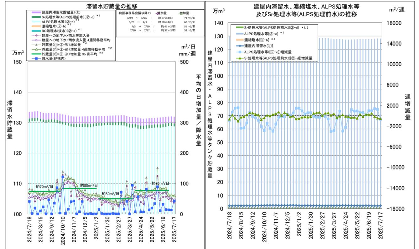
①：建屋内滞留水貯蔵量（1～4号機、プロセス主建屋、高温焼却炉建屋、廃液供給タンク、SPT(A)、SPT(B)、1～3号機 CST、パuffersタンク）
