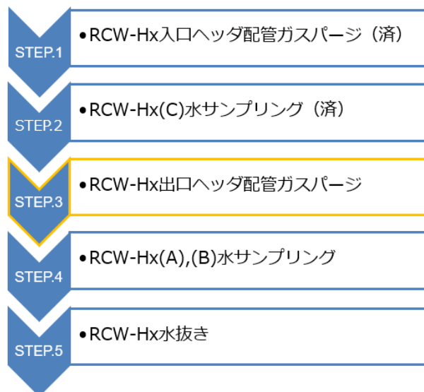
1号機RCW-Hxの線量低減の作業フロー
